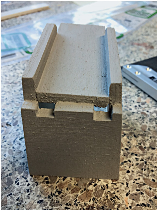
Das Sperrholzportal der neuen Brücke bekommt einen Betonanstrich.
