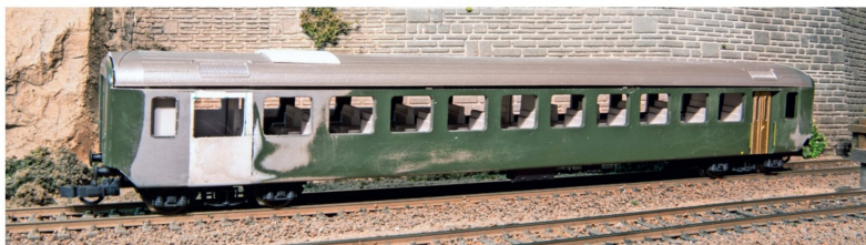
Der zukünftige Speisewagen im Rohbau mit verbauter Türe.
