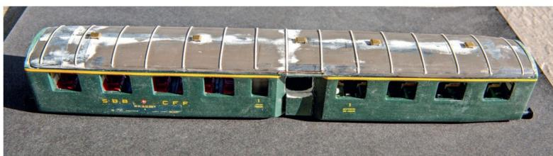
Hier sieht man die Eingriffe und Änderungen beim Dach sehr gut. Neben den Dachrippen sind auch die Dachlüfter bereits montiert.
