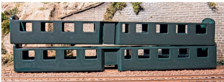
Ist der Wagenkasten fertig vorbereitet, kann die Farbgabeung angebracht werden. Fertig gespritzt ist der Wagen bereits gut erkennbar.
