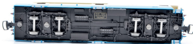
Beim Wagenunterboden wurden die Luftleitungen und -behälter der Bremsanlage nachgebildet.
