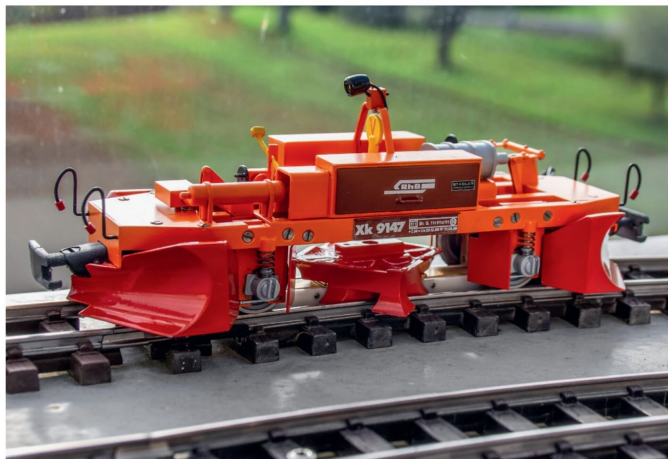
Der auf «Zwillingsskufen» aufgebaute Mittelpflug wird bei den Weichen automatisch angehoben.
