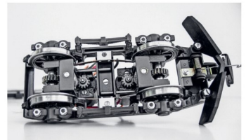
Der mit der Radachse starr verbundene Motor wird im Drehgestell per Tatzlagerung gehalten.
