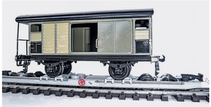
Verschiebbare Radkeile mit mechanischen Rasterungen sichern den Spur-0-Wagen.
