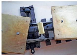
Die zwei Pufferteller werden mittels einer Kupplungslasche zusammengehalten,
