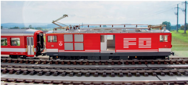
Bei diesem Eigenbaumodell wurden Antriebsdrehgestelle von Fama verwendet.
