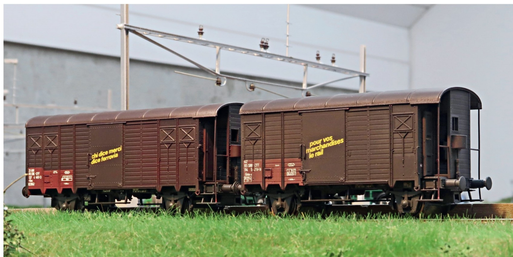
Stehen der längere K3, der als Grundmodell für den Umbau diente, und der kürzere K2 nebeneinander, erkennt man sofort die Unterschiede.
