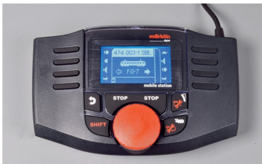
Nach Einschalten der Spannungsversorgung dauert es einen kleinen Moment, bis die Lok automatisch per mfx angemeldet ist.
