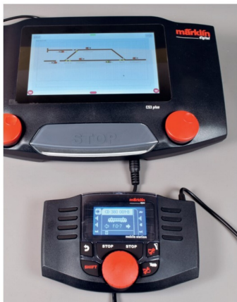
Die MS2 als Handregler an der CS3: So kann zum Beispiel auf der MS3 das Stellpult angezeigt und auf der MS2 zusätzlich eine Lok gesteuert werden.
