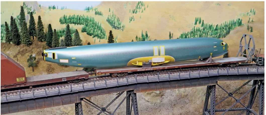
B737-Fuselage auf einem 89-Fuss-Flatcar. Für den nach hinten ausladenden Bereich des Flugzeugrumpfs wird jeweils ein weiterer Flatcar mitgeführt.
