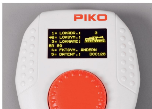
Im PIKO-Handregler sind etliche Loksymbole, Funktionssymbole und Zubehörsymbole gespeichert, die sich frei zuordnen lassen.
