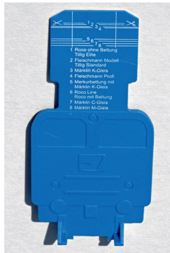
Das Viessmann-Werkzeug mit der Artikelnummer 4196 in Spur H0 zeigt an, in welcher Höhe die Drähte zu montieren sind. Nützlich ist auch die Mastpositionslehre (Art.-Nr. 4197, nicht im Bild).
