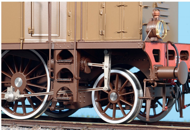
Ein tolles Schauspiel bietet der Antrieb des mechanischen Kompressors.
