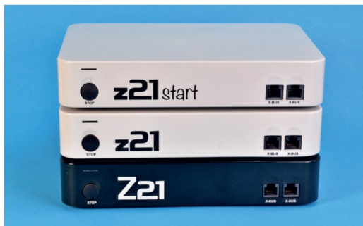
Z21-Zentralen im Vergleich: Die schwarze Z21 ist die grosse Zentrale und bietet zusätzliche Anschlüsse für Programmiergleis, CAN-Bus und LocoNet.
