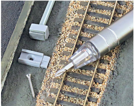
Mithilfe eines kleinen Schraubenziehers kann der Mastfuss nun auf der Grundplatte befestigt und dann mit Weissleim fixiert werden.
