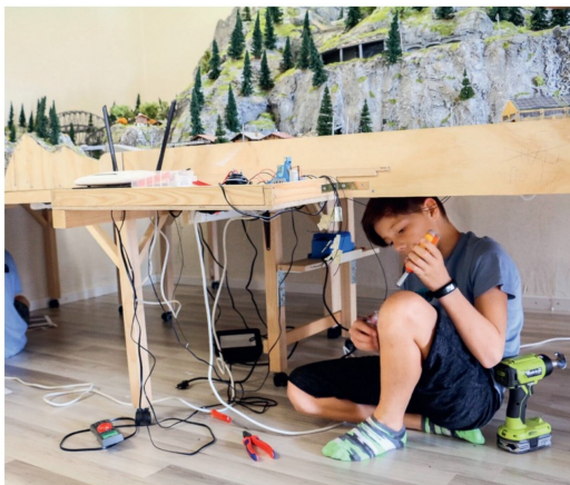
Tim erstellt mit einem Schrumpfschlauch eine neue Relaisverbindung.
