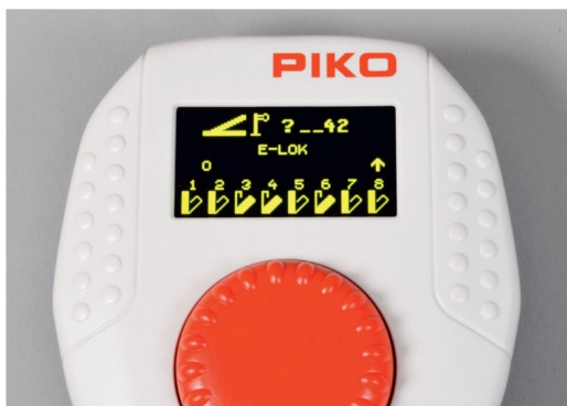
Weichenfunktionen lassen sich über Pfeiltasten blättern oder direkt über die Tastatur steuern. Triebfahrzeuge sind über den Drehregler steuerbar.
