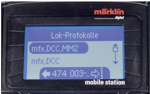
Die MS2 beherrscht Märklin Motorola 2 (MM2), DCC und mfx. Standardmässig sind alle drei Protokolle aktiv.
