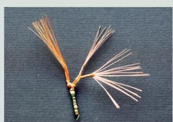
Ausfächerung durch Verdrehen der Kupferlitzen.
