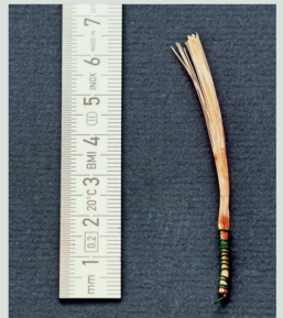
Abziehen der Restisolierung.
