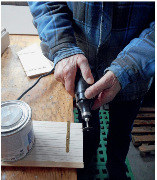
Die Arbeit der Türalterung wird von Hans Zoss mit dem Dremel ausgeführt.
