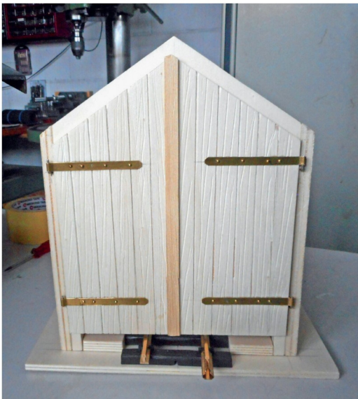
Das Abdeckbrettchen nicht vergessen. Es besteht aus einem 2×8-mm-Holz.
