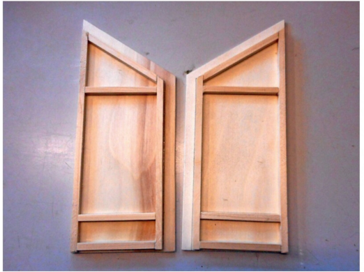
So werden die Verstrebungen aus Kantholz auf der Türrückseite montiert.
