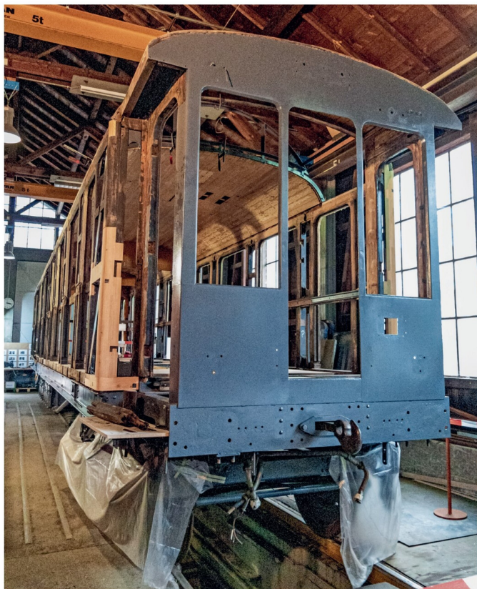
Durch die aufgearbeitete Wagenfront ist die rekonstruierte Aussichtskanzel im Dach ersichtlich.
