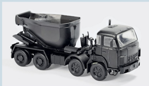
Ein erstes Modell aus schwarzem Kunststoff dient zum Testen der Formen.
