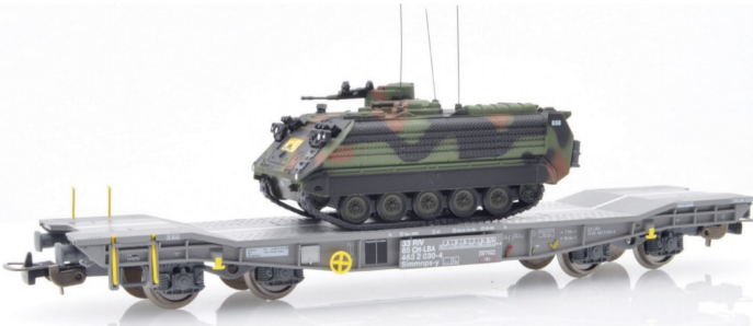
Der Panzer M113 auf einem SImmnps-y, der vorbildgerecht keine Bremsbacken hat.
