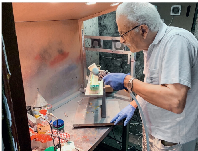
Der Initiant Hans Lei beim Spritzen im Nebenraum mit der Spritzkabine mit Abzugeinrichtung.
