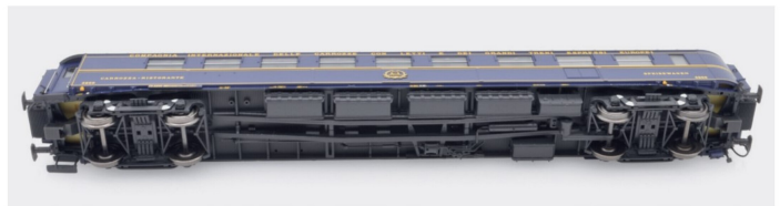
Die Gestaltung des Wagenunterbodens lässt dem Modellbahner keine Wünsche offen.
