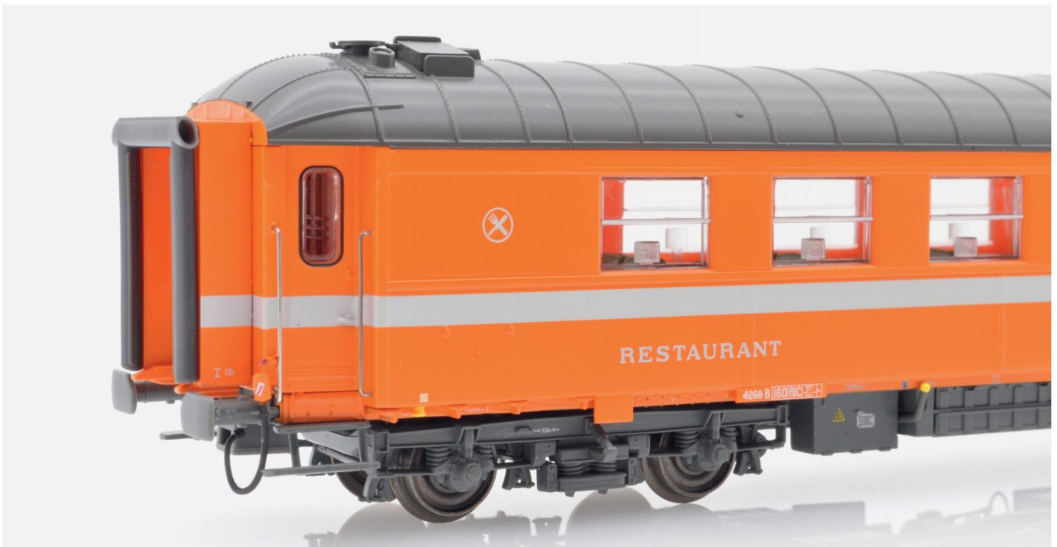
Der orange SNCB-Speisewagen weist einen verlängerten Wagenübergang mit Gummiwulst sowie neuen Minden-Deutz-Drehgestellen auf.
