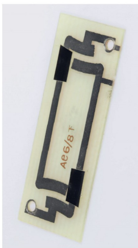
Die Klebestreifen verhindern Kurzschlüsse bei der Kurvenfahrt.
