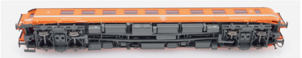
Auch der Wagenunterboden der SNCB-Version ist vorbildrichtig mit den später eingebauten Aggregaten und Kästen ausgestattet worden.
