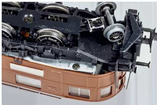
Die Gehäusebefestigungsschraube ist hinter dem Drehgestell versteckt.
