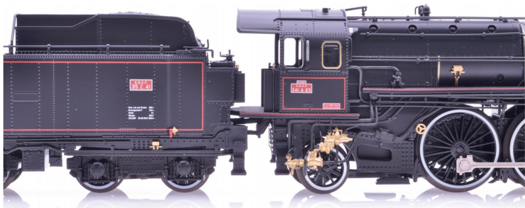
Der Abstand zwischen Lokomotive und Tender musste für die Kurventauglichkeit des Spur-H0-Modells etwas vergrössert werden.
