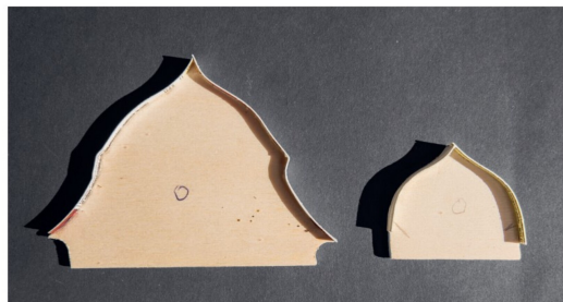
Für die Untersichten der grossen Gauben habe ich eine Schablone gebaut ...
