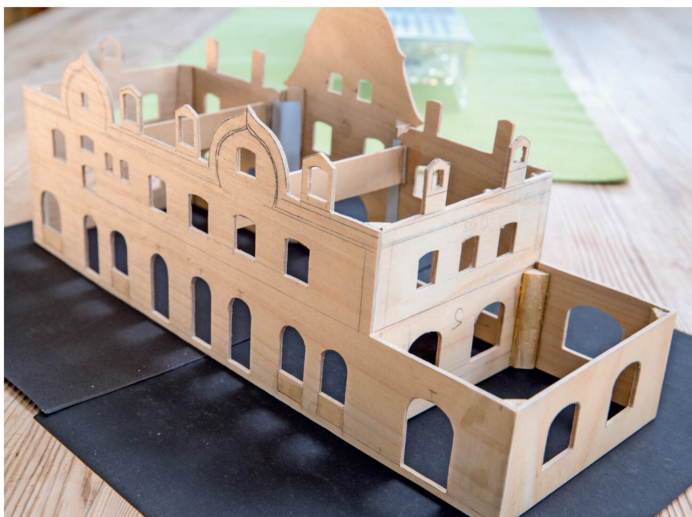
Die Sperrhölzer sind bereits zugesägt und mit dreikantigen Winkelhölzern zur Verstärkung verleimt.
