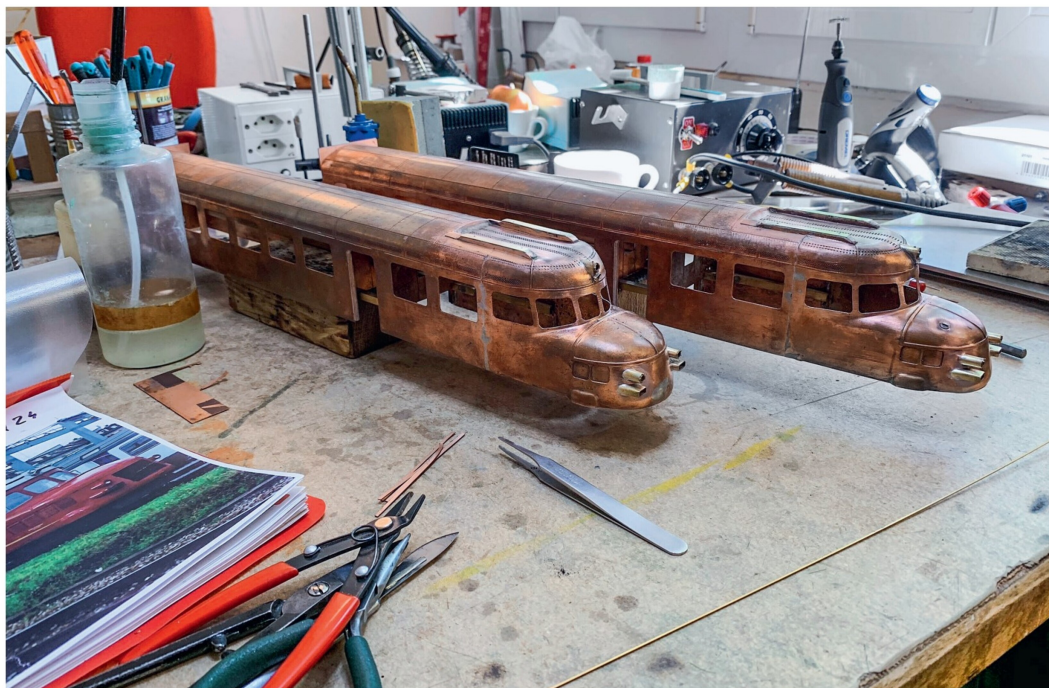
Ein Triebzug des RAe 4/8 im Bau. Das Gehäuse besteht aus geätztem Kupfer; die Form der Fronten wurde in einem galvanischen Verfahren hergestellt.
