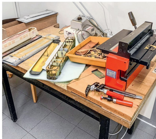
Die Biege- und Schneidemaschine ist zum Glück mobil und wird jeweils in der Sala Creativa aufgestellt. Daneben das Gehäuse des BLS-Wellensittichs.
