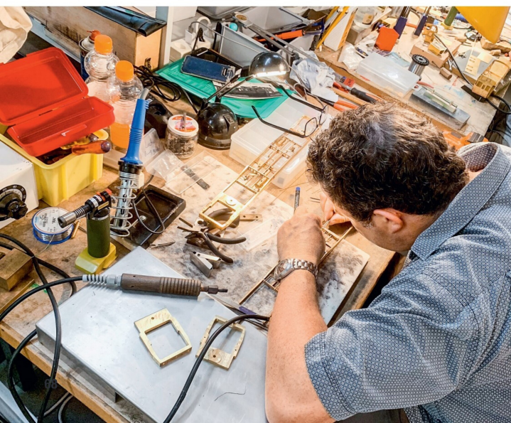
Ein Gehäuse des Cfe 4/5 der BLS ist am Entstehen. Der Teilesatz besteht aus vielen Ätz-, Fräs- und Drehteilen. Die Frästeile wurden durch den Entwickler auf der CNC-Fräse hergestellt.
