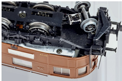
Die Gehäusebefestigungsschraube ist hinter dem Drehgestell versteckt.
