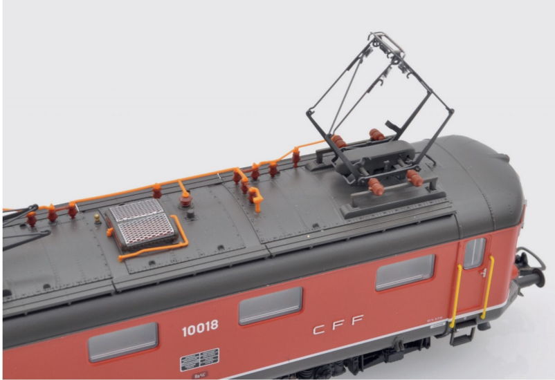
Blick auf das schön detaillierte Dach mit gehobenem Scherenstromabnehmer.
