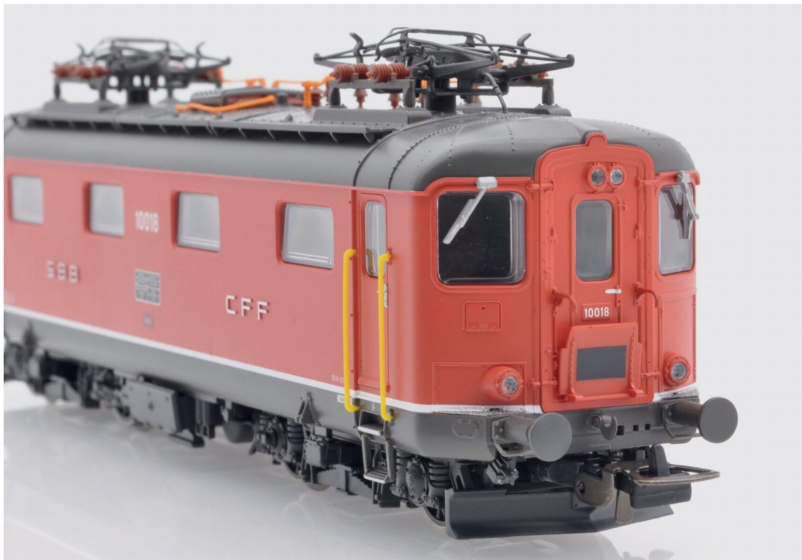
Frontansicht der Re 4/4' mit detailliertem und mehrfarbigem Übergangsblech im Auslieferungszustand ohne Zurlüftungsteile.
