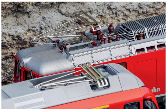
Vorbildmässige Pantografenstellung: Die Ge 4/4 ist fahrbereit, der Allegra hingegen abgestellt.
