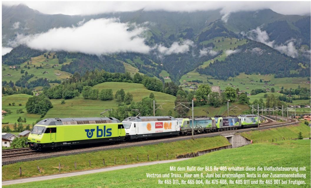
Mit dem Refit der BLS Re 465 erhalten diese die Vielfachsteuerung mit Vectron und Traxx. Hier am 6. Juni bei erstmaligen Tests in der Zusammenstellung Re 465 011, Re 465 004, Re 475 408, Re 485 011 und Re 465 001 bei Frutigen.
