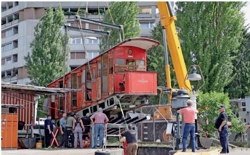
Aufsetzen auf die nachgebildete Gleisanordnung mit drei Schienen und zwei Zahnstangen entsprechend der damaligen Talstation am Central.
