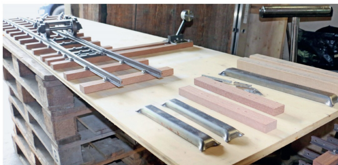
Verschiedene Schwellen aus Metall, Eichenholz (ganz rechts) und einem WPC genannten Verbund.
