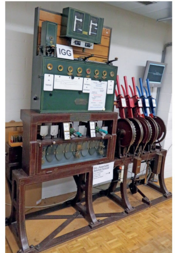
Die Drahtzüge liefern in einem Hebelstellwerk zusammen. An diesem lässt sich sehr anschaulich die Funktionsweise eines Stellwerks erläutern.
