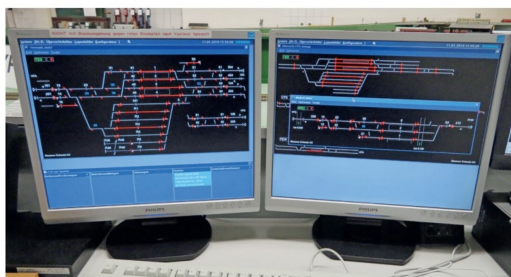
Vom ILTIS-Bedienplatz aus lassen sich alle Bahnhöfe ausser Igglswil und Zetthausen steuern. Die Vorgänge in Zetthausen können angezeigt werden.
