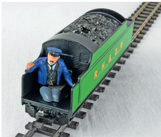
Der Lokführertorso verdeckt das Getriebe des Fahrgestells.
