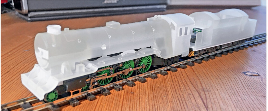
Frisch aus dem SLA-Drucker: der Aufbau der Lok No. 3 Southern Maid.
