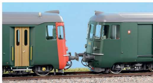
Es gibt deutliche Unterschiede der Dachform und der Dachlampen.
