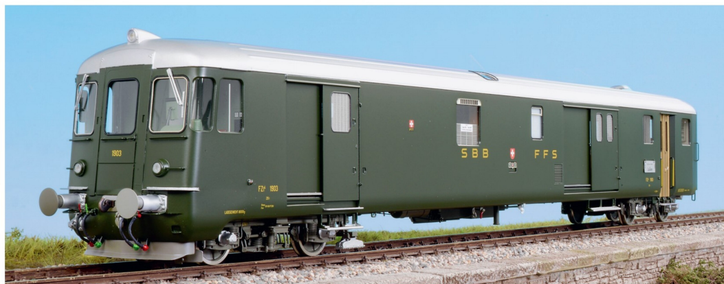
Ursprungsausführung des Gepäcksteuerwagens mit Postabteil und Dachfenstern. Die Pesolillo SA produzierte vier verschiedene Versionen.
