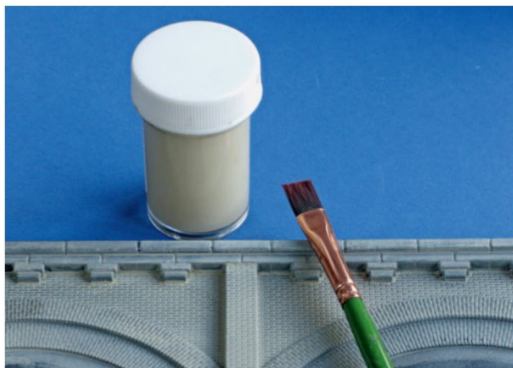
Ich habe leicht verdünnte Betonfarbe mit einem breiten Pinsel aufgetragen. Die Farbe füllte alle Fugen im Ziegel- und Mauerwerk aus.
