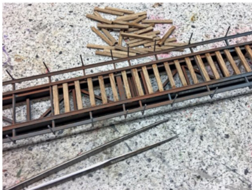
Die Holzschwellen werden auf die richtige Länge geschnitten und aufgeklebt.
