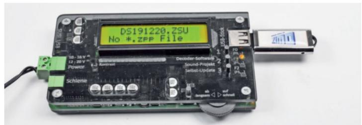
ZIMO MXULFA kann sowohl stand-alone als auch als PC-Gerät benutzt werden. Neben der Möglichkeit von Decoderupdates, dem Aufspielen von Sound, kann man das Gerät als Programmierstation und für Testfahrten verwenden. Ein RailCom-Detektor für das schnelle Auslesen von CVs ist integriert. Das Aufspielen von Updates funktioniert auch stand-alone. Die Updatedateien befinden sich hierbei auf einem USB-Stick.
