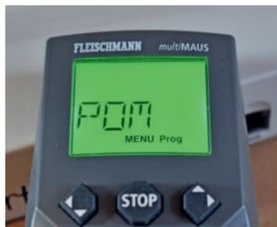
Auch mit der schon fast altehrwürdigen Multimaus kann man an Rocos z2!start schon per RailCom CVs auslesen.
