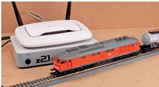
Bereits mit der als Einsteigerzentrale konzipierten weissen z21 von Roco kann man Decoder per RailCom lesen. Im einfachsten Fall geschieht dies mit Rocos Serviceprogramm Maintenance Tool und POM Read.
