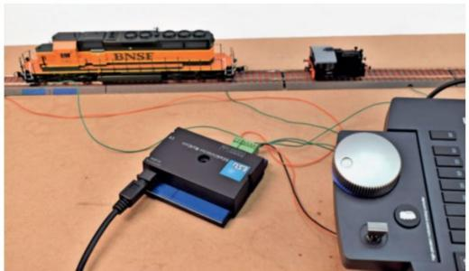
Der ECoS-Detektor RailCom ist ein echtes Plug-and-Play-Gerät. Eine Konfiguration ist nicht notwendig. Das Einbinden der Abschnitte in das Gleisbildstellpult der ECoS ist kinderleicht.
