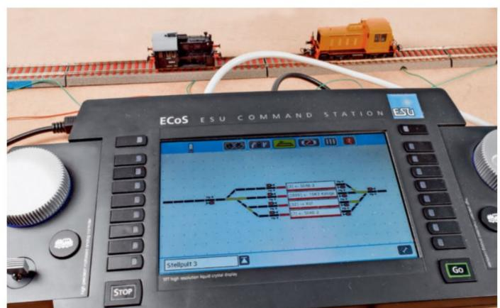
Im Gleisbildstellpult der ECoS kann man die RailCom-Abschnitte des Detektors ganz einfach einbinden. Angezeigt werden die Adresse, der Name und die Aufgleisrichtung. Bei einem Zweileiterystem kann man über RailCom erkennen, in welcher Richtung ein Fahrzeug auf dem Gleis steht.
