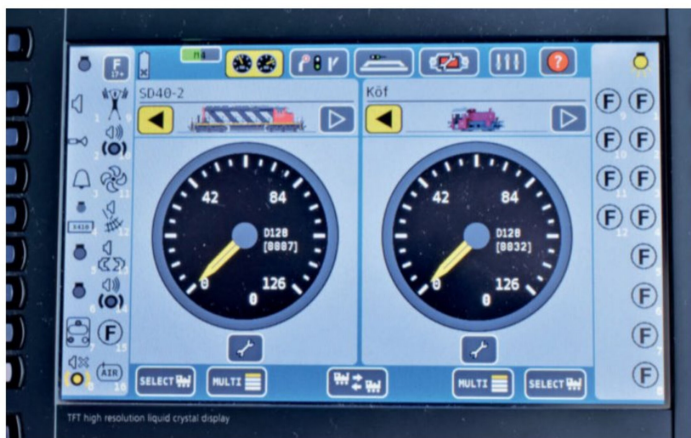
Die SD40-2 links wurde automatisch per RailComPlus angemeldet. Man kann hier auch die passenden Funktionssymbole sehen, die automatisch geladen wurden. Bei der Kof rechts sind nur Universalsymbole zu sehen, da diese Lok von Hand angelegt wurde. Oben links im grünen Verlaufsbalken läuft gerade noch das Anmeldeverfahren eines mfx-Decoders. Die automatische Anmeldung von mfx und diejenige von RailComPlus sind ähnlich, allerdings dauert die mfx-Anmeldung wesentlich länger.
