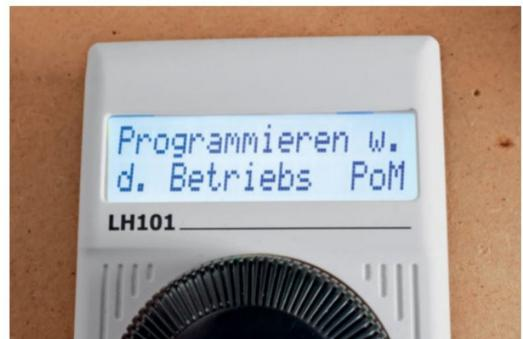
Der Lenz-Handregler LH101 unterstützt jetzt auch RailCom. So kann man im Betrieb CVs von Triebfahrzeugen lesen und muss dafür nicht extra ein Programmiergleis ansteuern. Die gelesenen Werte werden direkt im Display des Handreglers angezeigt.
