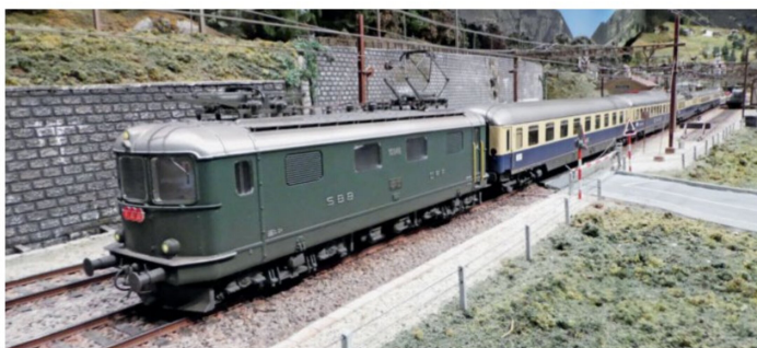
Re 4/4 1 , 57 t, 2,1 MW, Last: 20 A, 184 Pl., 244 t, V/max. 125 km/h.
