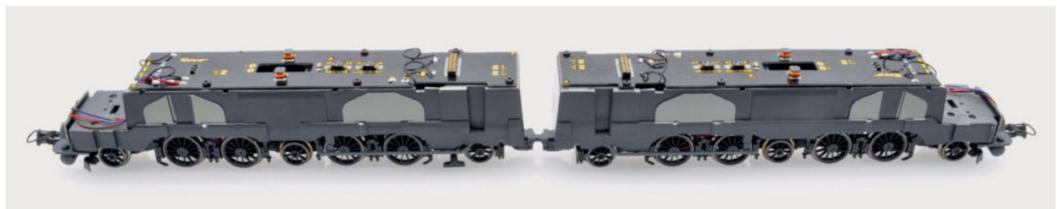
Unter dem Gehäuse steckt bewährte Technik: Zinkdruckgussrahmen mit Mittelmotor (nicht sichtbar) und die neue Platine.
