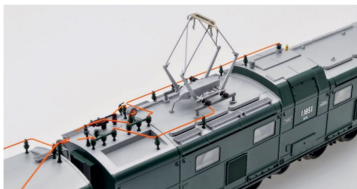
Sowohl filigran als auch funktional: der neu konstruierte BBC-Stromabnehmer in gehobenem Zustand.
