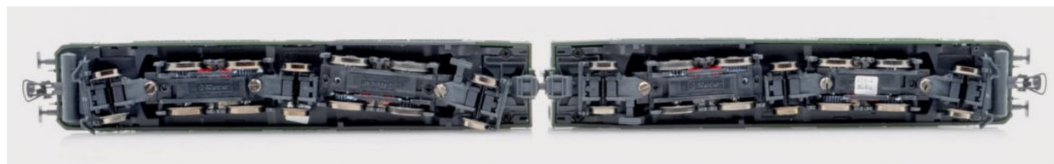
Blick auf das Fahrwerk mit seinen insgesamt 14 Achsen. Für die roten Zahnräder hätte auch schwarzer Kunststoff verwendet werden können.
