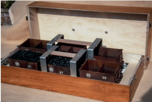
Als Transportsystem dient eine aus Holz gefertigte Box, die mit Aluminiumrinnen ausgestattet ist, um die Spurhaltung zu erleichtern.
