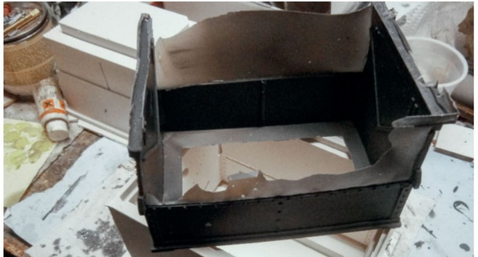
Die Silikonform für die Karosserie. Die beiden Teile passen dank den oberen und unteren Führungen perfekt zusammen. Dies ermöglicht einen konstanten Abstand von 2 mm zwischen beiden Teilen der Form. Die verschiedenen V-förmigen Vertiefungen dienen als Öffnungen für die zu entweichende Luft.
