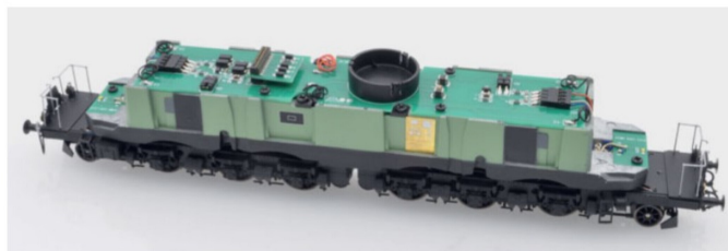
Klassischer Aufbau des Innenlebens mit Platine. Eine Schallkapsel für den Lautsprecher ist montiert.
