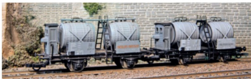
Bei diesen Weinwagen wurde das Bremserhaus durch eines von HAG ersetzt.
