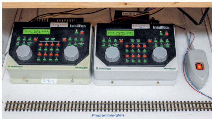
Übersicht über die Intellibox von Uhlenbrock mit dem Programmiergleis für die Triebfahrzeuge.
