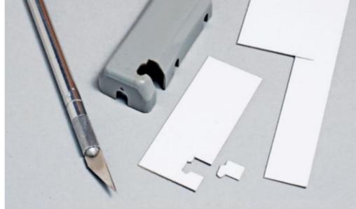
Die obere Abdeckung entsteht aus dünnem Karton, die Aussparung richtet sich nach der Öffnung in der grauen Verkleidung.
